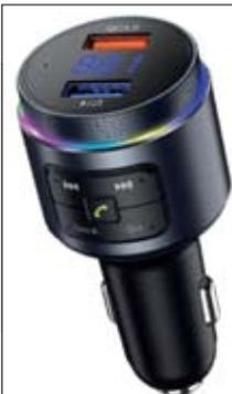
Bluetooth FM-Transmitter für alle Fahrzeuge mit einer 12-Volt-Batterie. Funktioniert mit allen Bluetooth-fähigen Mobilgeräten. Musik-Übertragung an das Autoradio ab Mobil-Telefon und USB-Stick. FM-Frequenzbereich zwischen 88.1 MHz und 107.9 MHz. Inklusive USB-Ladegerät mit QC3.0 Quick Charge.
